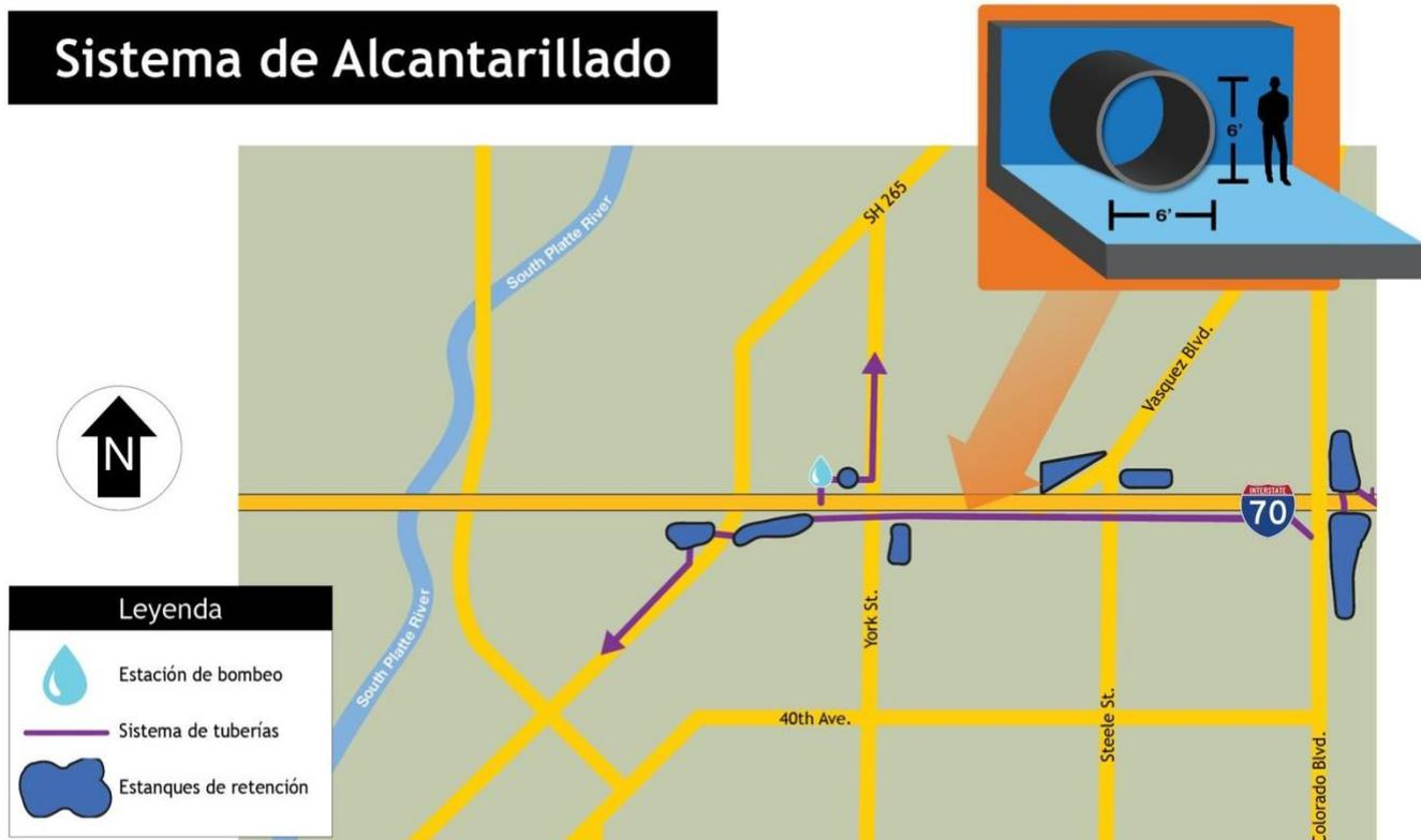
*El sistema de drenaje para la I-70 es una combinación de tuberías subterráneas y estanques de retención.*
