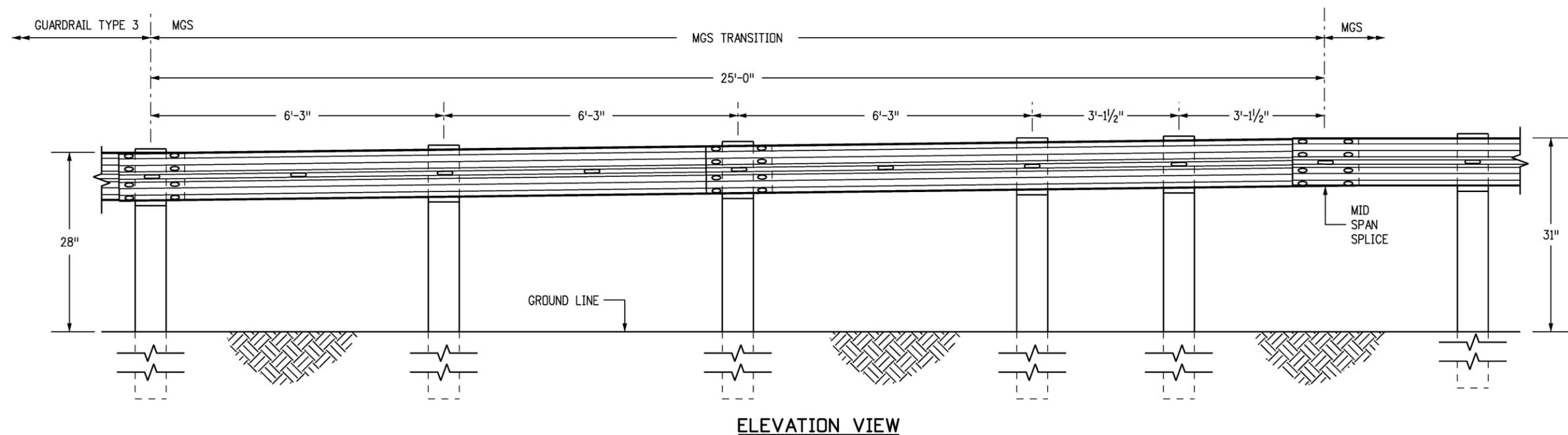
**TRANSITION FROM 28 INCH GUARDRAIL TO 31 INCH MGS FOR STEEL POST, NO BLOCK OPTION**
